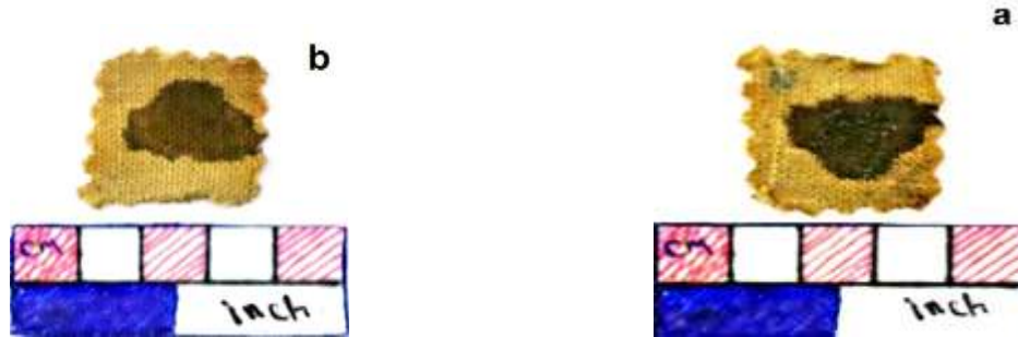
صورة (2) عينات الكتان المعالجة بأنزيم البروتيز المنتج من بكتريا B. lichiniformis P12 حيث " a " تمثل العينة قبل المعالجة بينما " b " تمثل العينة بعد المعالجة U 10 من الإنزيم لفترة زمنية قدرها 60 دقيقة.
