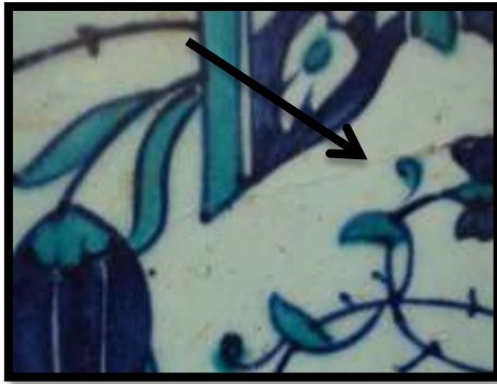
صورة رقم (2) توضح تواجد بعض البثور في طبقة التزجيج السطحية
